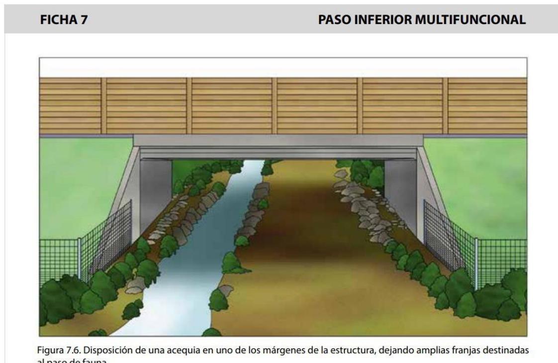
Este paso según las directrices del ministerio, PRESCRIPCIONES TÉCNICAS PARA EL DISEÑO DE PASOS DE FAUNA Y VALLADOS PERIMETRALES (SEGUNDA EDICIÓN, REVISADA Y AMPLIADA) , debería de tener unas medidas recomendadas de **15 metros de ancho por 3,5 de altura**, debido a la presencia de ciervo, medidas que son de indispensable aplicación para garantizar la efectividad del mismo.
