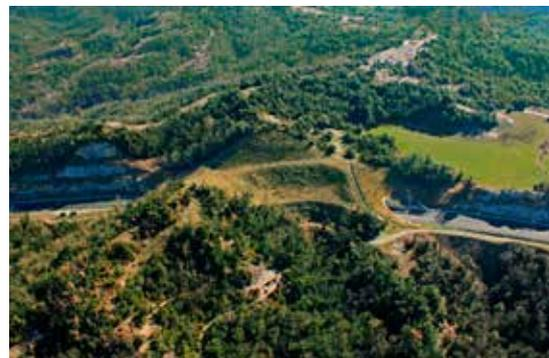
Figura 1.4. La superficie y los accesos del ecoducto deberán tener perfiles topográficos similares a los del paisaje del entorno. Foto: Minuartia.
