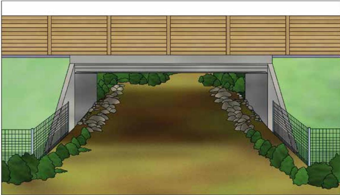
Figura 6.1. Esquema general de un paso inferior específico.
